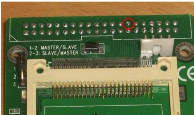
3. Am CF-Karten-Adapter ist eine Modifikation notwendig, damit er ohne einen Kurzschluss zu verursachen am CPC läuft. Den Cable Select Pin [28] entlöten und mit einer Zange aus der Buchse am Adapter ziehen. Und schon funktioniert das Teil!
